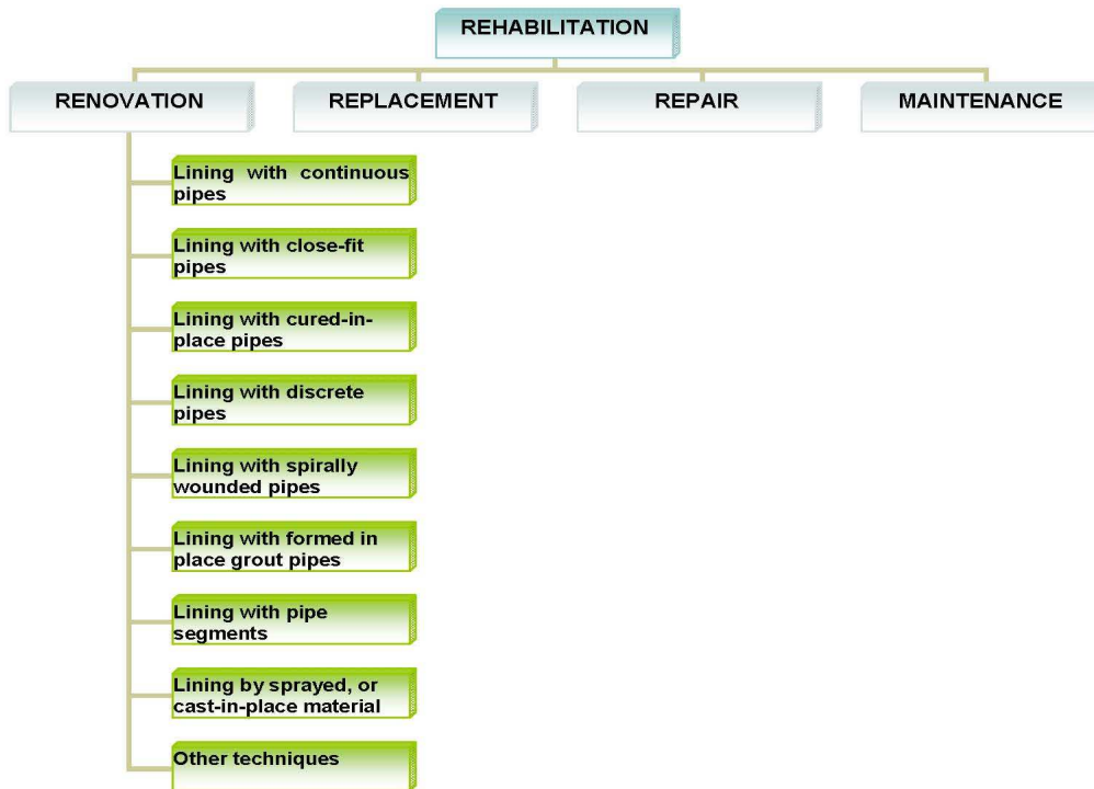
Figure: Renovation techniques (EN 15885)
