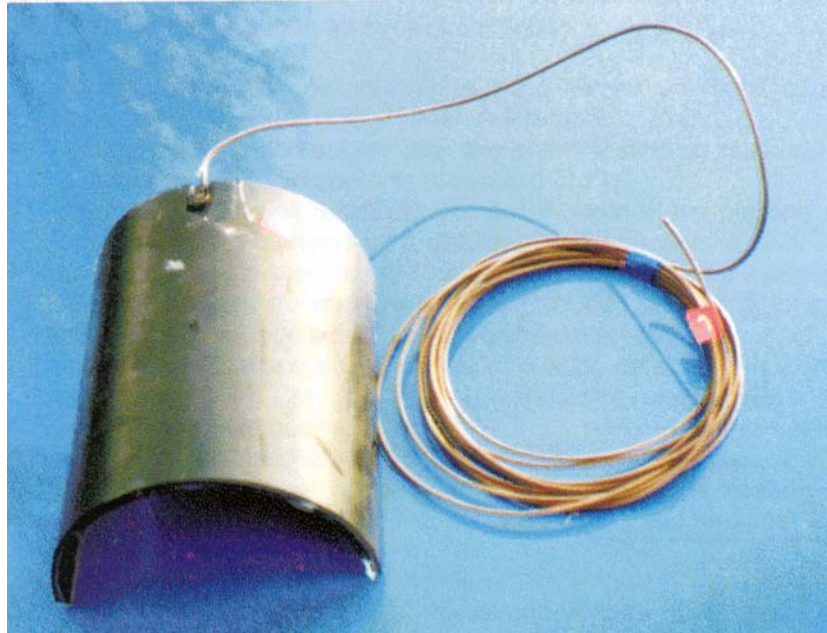
Image 4-B Echantillon de corrosion
