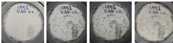
Abbildung 3 Einfluss von Strom auf das Schadensbild, leicht kalklösend (pH 7.4, alkalisch), Bild HSR Influence of direct current (DC) to the surface of the concrete samples, pH 7.4, alkaline
