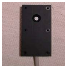
Fig. 3 – a.c. corrosion coupon
