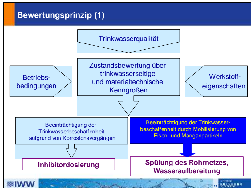
Bild 1: Vorgehensweise bei der Korrosionsanalyse (Baustein 1)
