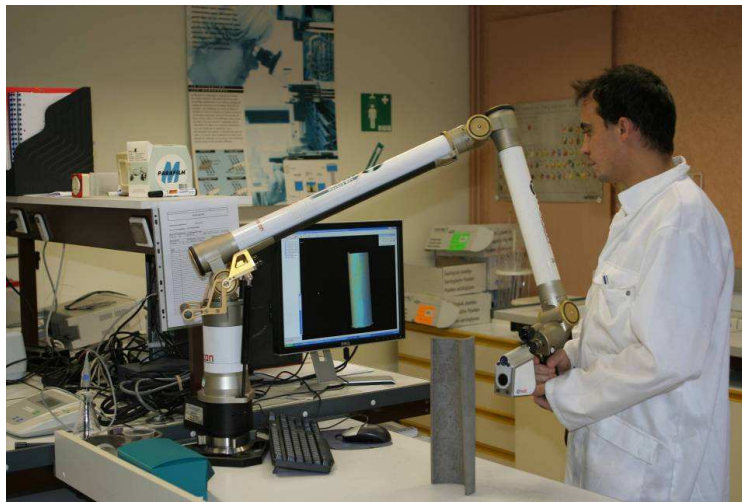
Figure 2 : Numérisation par profilométrie laser d'un échantillon de canalisation en fonte
