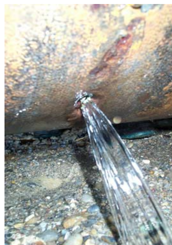
Abbildung 4: Typischer Rohrschaden an duktiler Gussleitung der 1. Generation, verursacht durch Holzunterlagen
