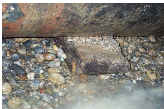
Abbildung 4: Typischer Rohrschaden an duktiler Gussleitung der 1. Generation, verursacht durch Holzunterlagen
