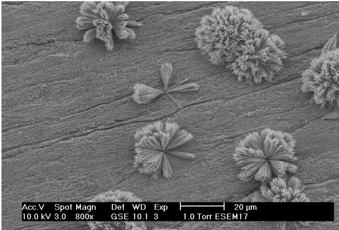
Bild 5: Rasterelektronenmikroskopische Aufnahme einer korrodierten Rohrinnenoberfläche [11,12].
